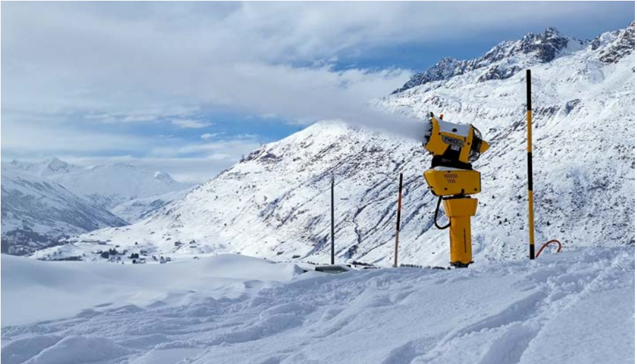
Abb. 1: Beschneigung mit Schneekanone. Moderne Anlagen beschneien mit einer Pumpleistung von 270 \text{ L s}^{-1} Wasser (Foto: E. Hiltbrunner).
